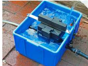
Fill the evaporator
